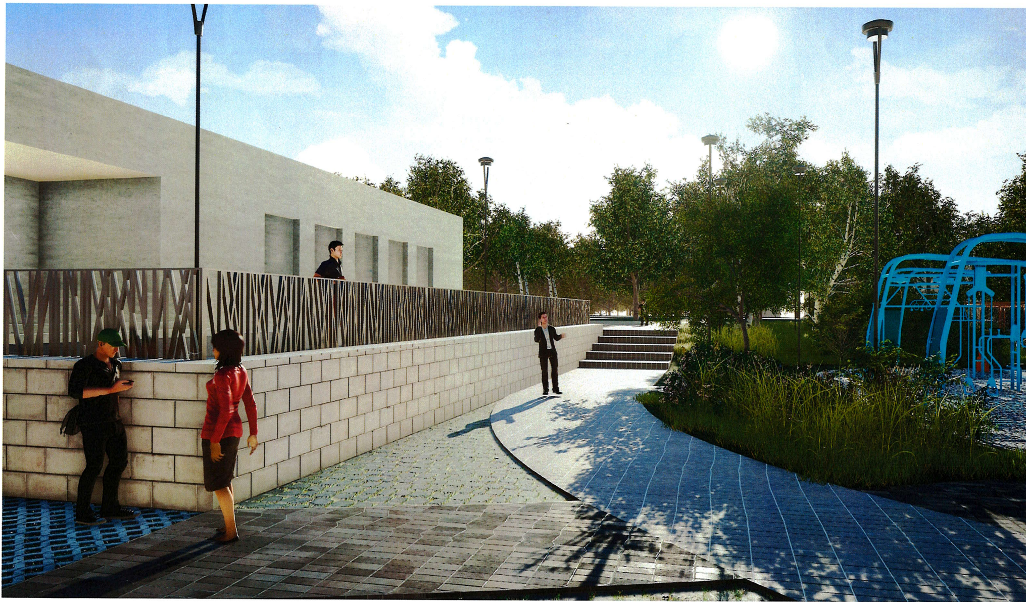
Реконструкция подпорной стены с установкой металлических перил. Ветви деревьев отражены в геометрическом рисунке стоек ограждения. Лестничный спуск изготовлен из бетонных ступеней.
