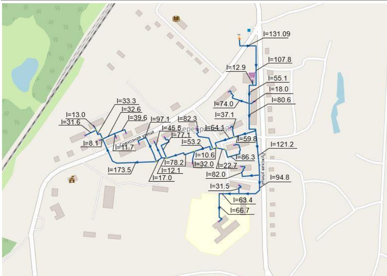
Рисунок 5. Схема тепловых сетей посёлка Серебрянский с указанием протяженности тепловых сетей (в двухтрубном исполнении)
