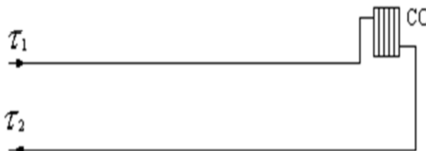
Рисунок 7. Схема подключения абонентов по зависимой схеме отопления
